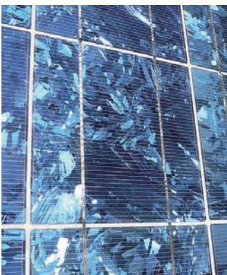
Polykristalline Silizium-Solarzellen in einem Solarmodul
